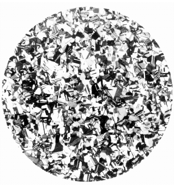
晶粒平均直径 0.020 mm (75×0.025 mm)
